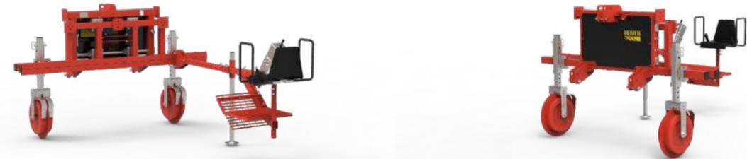
En présence de RTK sur le tracteur, le conducteur peut déplacer en déport les éléments de la sardeuse en contrôlant 1 ou plusieurs rangées sur un écran HD 10,4" avec le joystick positionné en cabine. Possibilité d'avoir des extensions latérales repliables pour le transport sur route.
