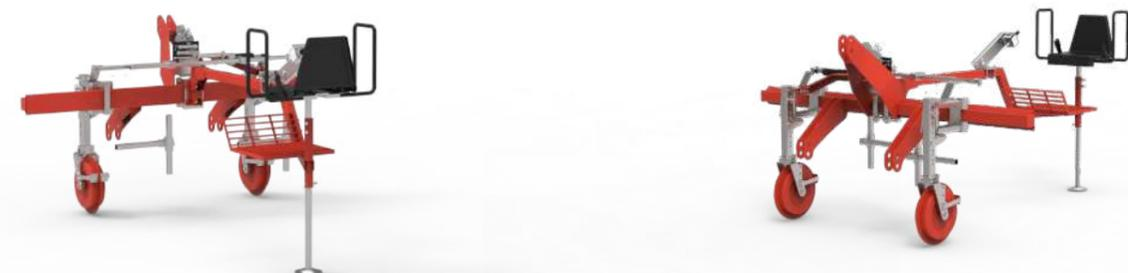
4. **Châssis hydraulique déporté, roues fixes, guidage Joystick et assise pour l'opérateur.**
